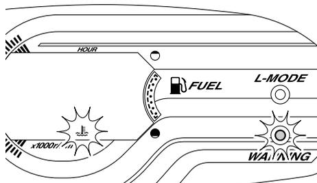
Se o avisador de sobreaquecimento do motor for activado, reduzir imediatamente a velocidade do motor, voltar a terra e verificar se existe descarga de água pela saída piloto da água de refrigeração com o motor em funcionamento. Caso não haja descarga de água, desligar o motor e verificar se a tomada do jacto está obstruída. (Ver mais informações sobre a tomada do jacto na página 93.)
