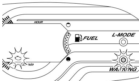
Se a luz avisadora de verificação do motor for activada, reduzir imediatamente a velocidade do motor, voltar a terra e solicitar a verificação do motor a um Concessionário Yamaha.
