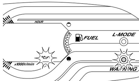
Se a luz avisadora da pressão do óleo for activada, reduzir imediatamente a velocidade do motor, voltar a terra e verificar o nível do óleo do motor. (Ver as informações sobre a verificação do nível do óleo do motor na página 48.) Se o nível do óleo for suficiente, solicitar a um Concessionário Yamaha a verificação do veículo aquático.
