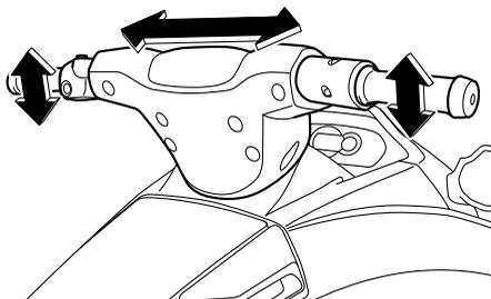
Virar totalmente o guiador para a esquerda e para a direita para verificar se a tubeira do jacto se move quando o guiador é virado e se não há diferença entre as posições da tubeira
