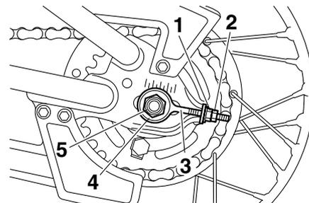
1. Écrou de réglage de la tension de la chaîne de transmission
