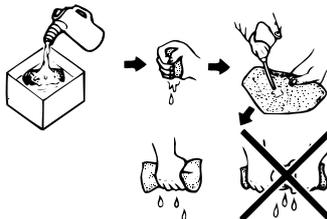
4. Enduire toute la surface de l'élément en mousse d'huile du type recommandé, puis éliminer l'excès d'huile en comprimant l'élément.
