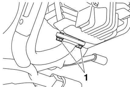
1. Vis de tubulure d'échappement
