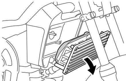
3. Séparer l'élément en mousse du couvercle du boîtier de filtre à air et le nettoyer dans du dissolvant, puis éliminer le dissolvant en le comprimant.
