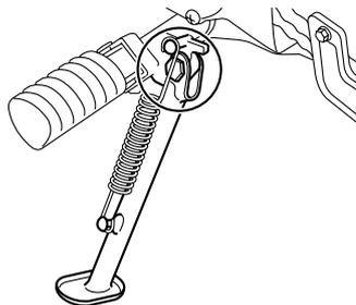
Contrôler le fonctionnement de la béquille latérale avant chaque départ et lubrifier son articulation et les points de contact des surfaces métalliques quand nécessaire.
