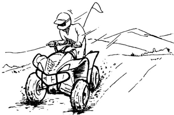
Si les roues arrière commencent à déraper, il est possible de regagner le contrôle du véhicule (si l'espace disponible est suffisant) en manœuvrant dans la direction du dérapage. Il est déconseillé de freiner ou d'accélérer avant d'avoir repris le contrôle du véhicule.
