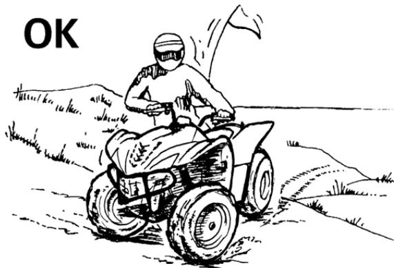
Si le VTT a calé ou s'il s'est arrêté et que l'on juge pouvoir atteindre le sommet de la côte, redémarrer prudemment afin que les roues avant ne se soulèvent pas, car cela entraînerait la perte de contrôle du véhicule. S'il est impossible de continuer l'ascension, descendre du VTT. Tourner le VTT en le poussant, puis redescendre la colline.
