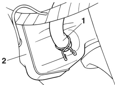
1. Tubo flexible del depósito de líquido refrigerante
