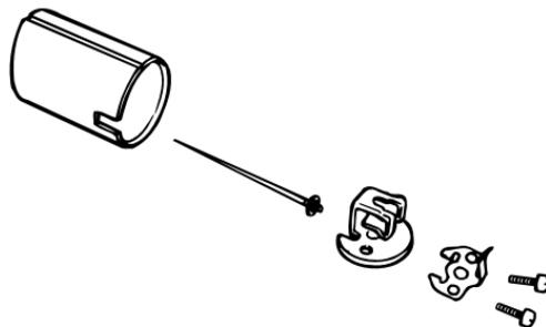
12. Extraiga el carburador y luego extraiga la cámara del flotador quitando los tornillos.
