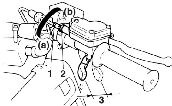
1. Perno de ajuste del juego libre de la palanca del acelerador
