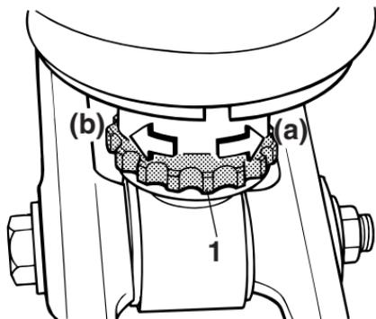
1. Dial de ajuste del hidráulico de extensión
