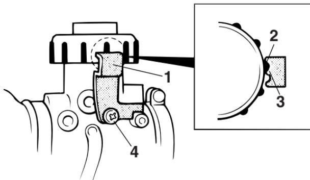
1. Placa de seguridad de la tapa de la cámara de mezcla
