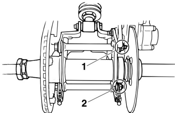
1. Tuerca de sujeción del eje (superior)
