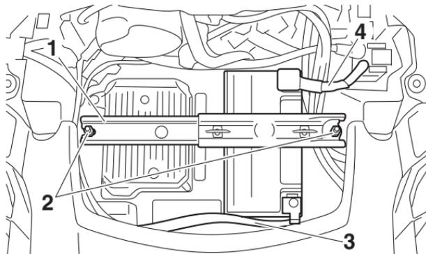
1. Placa de sujeción de la batería
