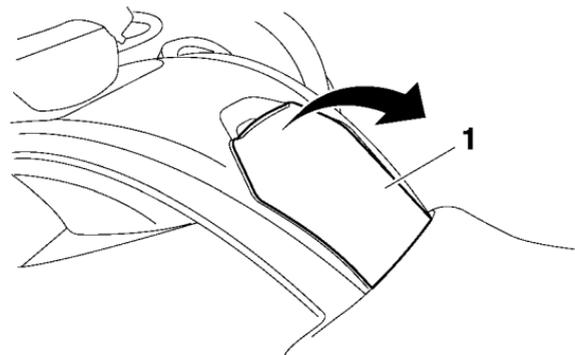
1. Cubierta del tapón del depósito de gasolina
