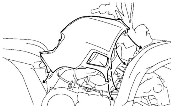
2. Instale los paneles A y C.
