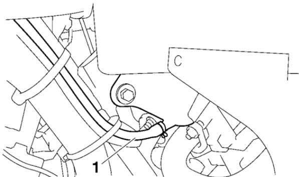
1. Tubo flexible del depósito de líquido refrigerante
