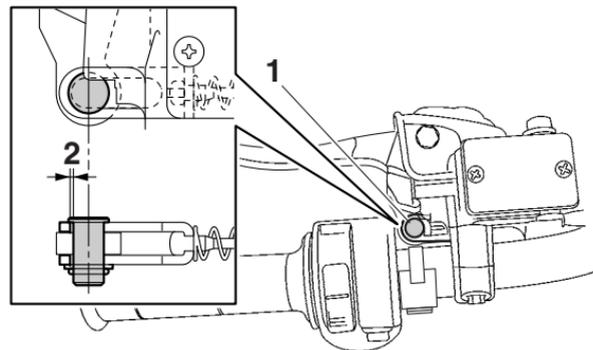
1. Unión del cable del pedal de freno
