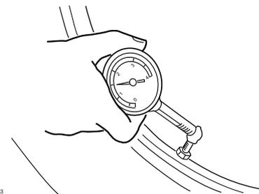
Debe comprobar la presión de aire de los neumáticos antes de cada utilización y, si es necesario, ajustarla.
