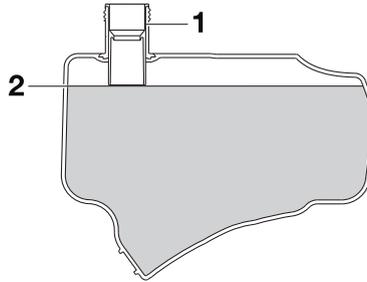
1. Orificio de llenado del depósito de gasolina
