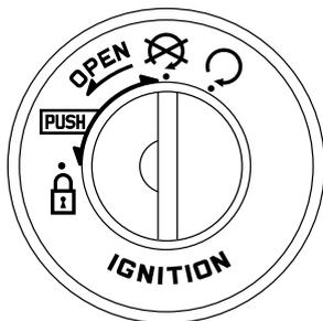
El interruptor principal/bloqueo de la dirección controla los sistemas de encendido y luces y se utiliza para bloquear la dirección. A continuación se describen las diferentes posiciones.
