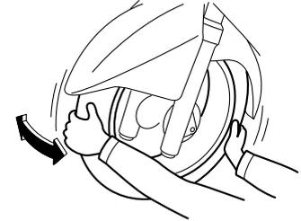
Debe comprobar los cojinetes de las ruedas delantera y trasera según los intervalos que se especifican en el cuadro de mantenimiento periódico y engrase. Si existe juego en el cubo de la rueda o ésta no gira con suavidad, solicite a un concesionario Yamaha que revise los cojinetes de la rueda.
