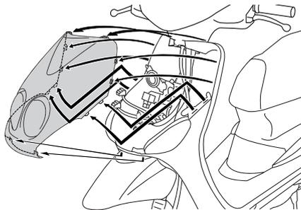
2. Desconecte el acoplador del faro y el acoplador del cable de la luz de posición.
