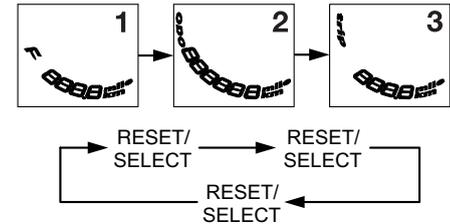
Para poner un cuentakilómetros parcial a cero, selecciónelo pulsando el botón y seguidamente púlselo de nuevo durante al menos tres segundos. Si no pone a cero de forma manual el cuentakilómetros parcial en reserva de gasolina, este se pondrá a cero automáticamente y se restablecerá la visualización del modo anterior después de repostar y de recorrer 5 km (3 mi).
