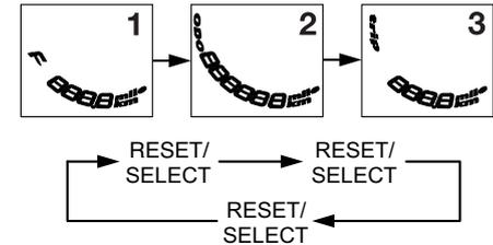
Se si accende l'indicatore d'avvertimento livello carburante (vedi pag. 3-2), il display del totalizzatore contachilometri cambierà automaticamente passando in modalità contachilometri parziale riserva carburante "TRIP F" ed inizierà a conteggiare la distanza percorsa a partire da quel punto. In tal caso, premendo il tasto sul display si alterneranno le varie modalità di contachilometri parziale e totalizzatore contachilometri nel seguente ordine:
