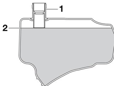
1. Foro di rifornimento del serbatoio del carburante
