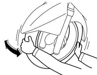
Si devono controllare i cuscinetti della ruota anteriore e posteriore agli intervalli specificati nella tabella della manutenzione periodica e lubrificazione. Se c'è del gioco nel mozzo della ruota, o se la ruota non gira agevolmente, fare controllare i cuscinetti delle ruote da un concessionario Yamaha.
