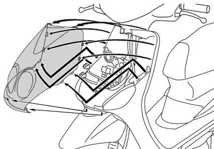
2. Scollegare il connettore faro, ed il connettore cavo luce di posizione.
