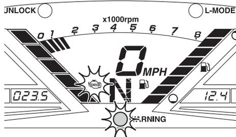
Wenn die Motor-Warnleuchte aufleuchtet, sofort die Motordrehzahl drosseln, das Wasserfahrzeug an Land bringen und den Motor von einem Yamaha-Händler kontrollieren lassen.
