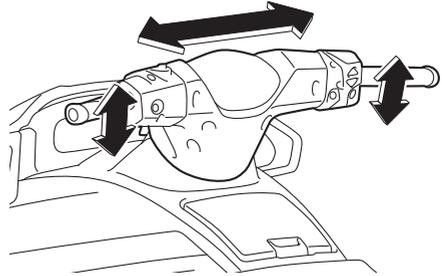
Den Lenker so weit wie möglich nach rechts und links drehen um sicherzustellen, dass sich die Jetdüse mit den Lenkerdrehungen bewegt und dass es keinen Unterschied zwi-
