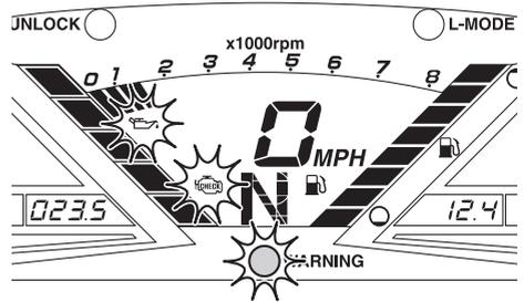
Wenn die Öldruck-Warnanzeige erscheint, sofort die Motordrehzahl drosseln, das Wasserfahrzeug an Land bringen und den Motorölstand kontrollieren. (Weitere Angaben zum Kontrollieren des Motorölstands siehe Seite 56.) Falls ausreichend Öl vorhanden ist, das Wasserfahrzeug von einem Yamaha-Händler kontrollieren lassen.
