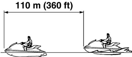
Wenn der RiDE-Hebel zum Abbremsen betätigt wird, ist der Bremsweg ca. 30% kürzer als ohne Verwendung des RiDE-Hebels. Allerdings können Faktoren wie das Gesamtgewicht, die Bedingungen der Wasseroberfläche und die Windrichtung diesen Abstand beeinflussen.
