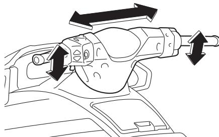
Περιστρέψτε τις χειρολαβές του τιμονιού τέρμα δεξιά και αριστερά για να βεβαιωθείτε ότι το ακροφύσιο πηδαλιουχίας κινείται καθώς περιστρέφονται οι χειρολαβές, καθώς και ότι δεν υπάρχει διαφορά μεταξύ των θέσεων τέρμα δεξιά
