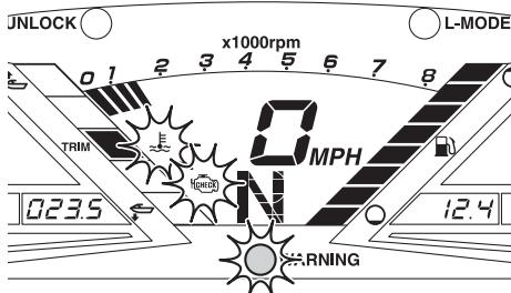
Αν ενεργοποιηθεί η προειδοποίηση πίεσης λαδιού, μειώστε αμέσως τις στροφές του κινητήρα, επιστρέψτε στην ακτή και ελέγχετε τη στάθμη λαδιού του κινητήρα. (Βλ. σελίδα 55 για πληροφορίες σχετικά με τον έλεγχο της στάθμης λαδιού του κινητήρα.) Εάν η στάθμη λαδιού υποδεικνύει επαρκή ποσότητα, απευθυνθείτε σε έναν αντιπρόσωπο της Yamaha για έλεγχο του υδροσταθμούς.
