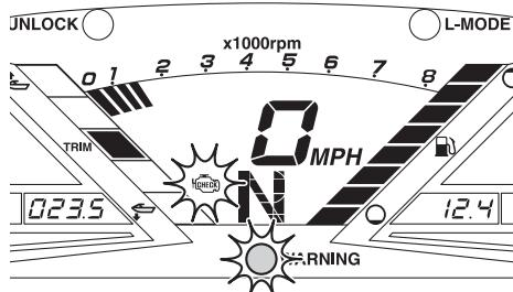
Αν ενεργοποιηθεί η προειδοποίηση ελέγχου κινητήρα, μειώστε αμέσως τις στροφές του κινητήρα, επιστρέψτε στην ακτή και ζητήστε από έναν αντιπρόσωπο της Yamaha να ελέγξει τον κινητήρα.
