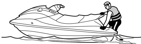
(3) Δέστε το κορδόνι ασφαλείας του κινητήρα (αναδέτης) στον αριστερό καρπό σας και, στη συνέχεια, τοποθετήστε την ασφάλεια στο διακόπτη ασφαλείας του κινητήρα.
