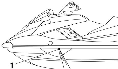
1 Surtidor testigo del agua de refrigeración
