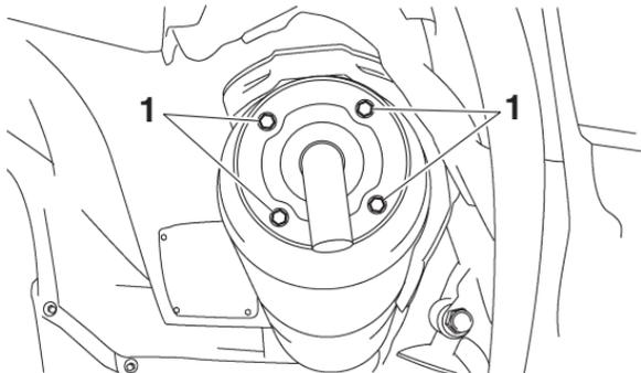
1. Vis de tube d'échappement arrière
