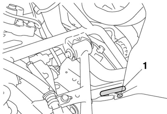
1. Numéro d'identification du véhicule (côté avant gauche)
