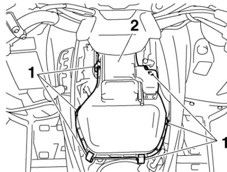
1. Attache du couvercle du boîtier de filtre à air
