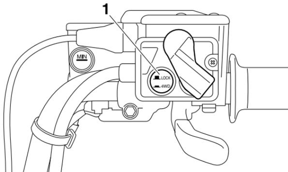
1. Commutateur de blocage du différentiel “4WD”/“LOCK”
