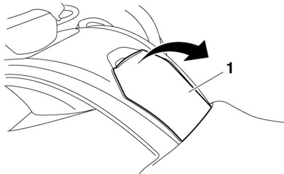
1. Cache du bouchon de réservoir de carburant
