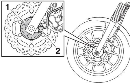
1. Rotor de capteur de roue avant
