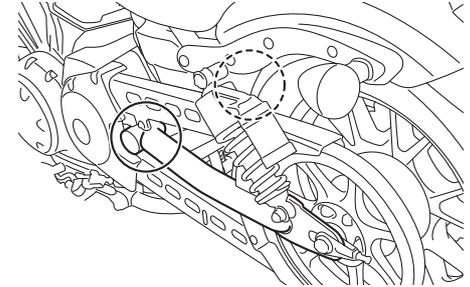
Faire contrôler les pivots du bras oscillant par un bras oscillant aux fréquences spécifiées dans le tableau des entretiens et graissages périodiques.
