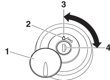
1. Cache-serrure du bouchon de réservoir de carburant
