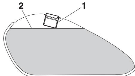
1. Tube de remplissage du réservoir de carburant
