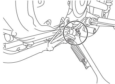
Contrôler le fonctionnement de la béquille latérale avant chaque départ et lubrifier son articulation et les points de contact des surfaces métalliques quand nécessaire.
