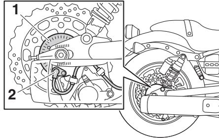
1. Rotor de capteur de roue arrière
