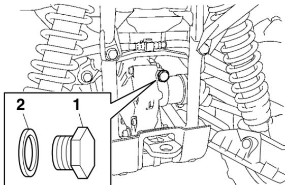
1. Bouchon de remplissage d'huile de couple conique arrière
