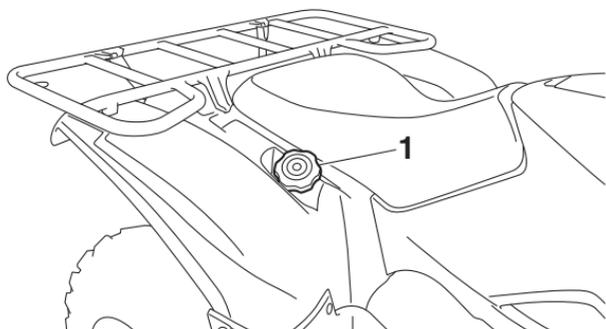
1. Bouchon du réservoir de carburant
