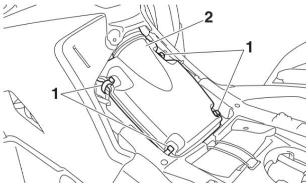
1. Attache du couvercle du boîtier de filtre à air
