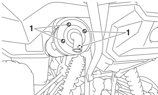
1. Vis de tube d'échappement arrière
