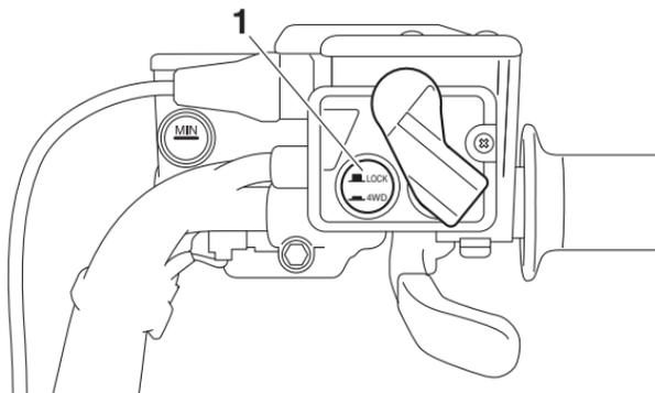
1. Commutateur de blocage du différentiel “4WD”/“LOCK”
