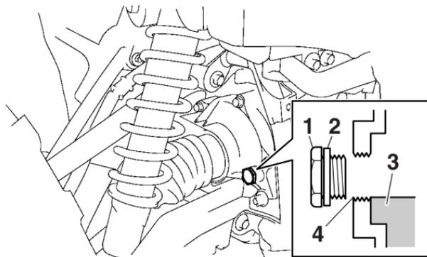
1. Bouchon de remplissage de l'huile de différentiel
