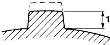
1. Limite d'usure de pneu
