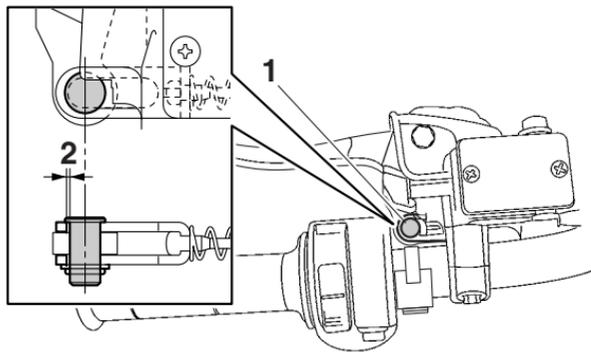
1. Unión del cable del pedal de freno
