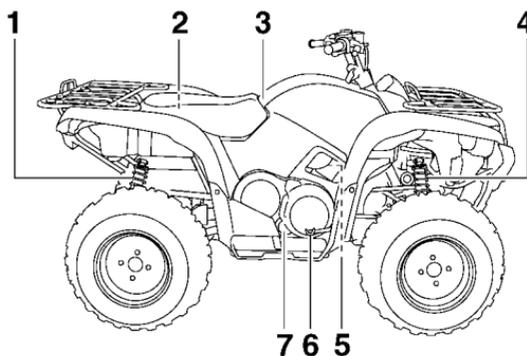
1. Anillo de ajuste de la carga previa del resorte del conjunto del amortiguador trasero
