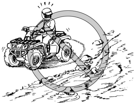
Compruebe los frenos cuando salga del agua. Si es necesario, frene varias veces para que el rozamiento seque los forros. No siga conduciendo el ATV sin comprobar que éste ha recuperado su capacidad de frenado. **¡ADVERTENCIA! Si los frenos están mojados, la capacidad de detener el vehículo puede verse reducida, con el consiguiente riesgo de perder el control.** [SWB02622]
