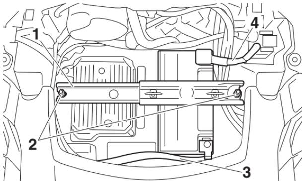
1. Placa de sujeción de la batería
