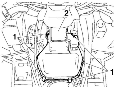
1. Soporte de la cubierta de la caja del filtro de aire
