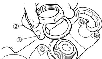
9. Après avoir serré l'écrou, vérifier si le mouvement de la direction est régulier. Sinon, régler la direction en desserrant petit à petit l'écrou.
