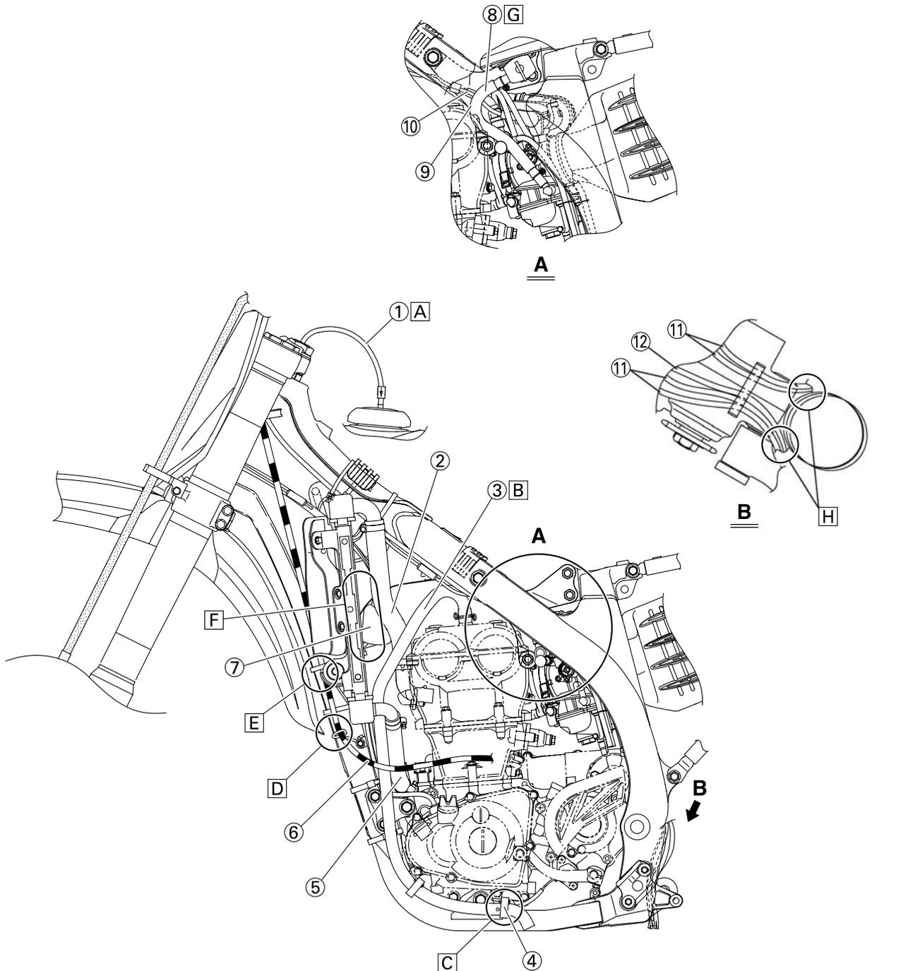
1. Durit de mise à l'air du réservoir de carburant
