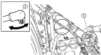
10. Placer les repères d'alignement "a" sur le capteur de position du papillon et le carburateur.
