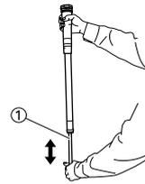
12. Protéger l'amortisseur "1" à l'aide d'un chiffon et le comprimer complètement pour permettre à l'excédent d'huile de s'écouler du côté de la soupape de base.
