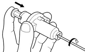
b. La tige étant complètement enroulée et le repère UP "a" du tendeur étant orienté vers le haut, monter le joint "1", le tendeur de chaîne de distribution "2" et le joint "3", puis serrer le boulon "4" au couple spécifié.
