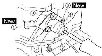
c. Retirer le tournevis, contrôler que la tige du tendeur ressort et serrer le joint "5" et le boulon-capuchon "6" au couple spécifié.
