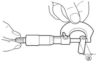
b. Mesurer le diamètre intérieur (piston) "b".
