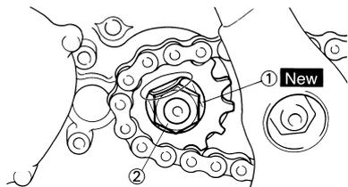
3. Plier l'onglet de la rondelle-frein pour bloquer l'écrou.
