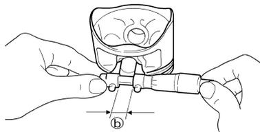
c. Calculer le jeu entre axe de piston et piston au moyen de la formule suivante.
