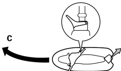
D. Se o motor for desligado durante a condução, não há impulso. O veículo desloca-se a direito, mesmo que o guiador seja virado.
