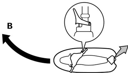
C. A libertação completa do comando do acelerador produz apenas o impulso mínimo. A velocidades superiores à velocidade mínima de governo, a capacidade de governo sem aceleração do motor diminui rapidamente. Imediatamente após a libertação do comando do acelerador pode ainda haver alguma capacidade de viragem, mas depois de o motor abrandar, o veículo deixa de responder ao guiador, até que o acelerador seja novamente aplicado ou até ser atingida a velocidade mínima de governo.
