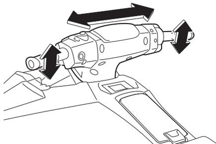
Virar totalmente o guidador para a esquerda e para a direita para verificar se a tubeira do jato se move quando o guidador é virado e se não há diferença entre as posições da tubeira
