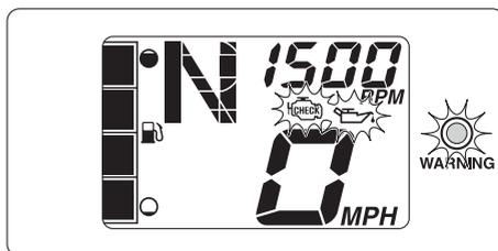
Se a luz avisadora da pressão do óleo for ativada, reduzir imediatamente a velocidade do motor, voltar a terra e verificar o nível do óleo do motor. (Ver as informações sobre a verificação do nível do óleo do motor na página 49.) Se o nível do óleo for suficiente, solicitar a um Concessionário Yamaha a verificação do veículo aquático.
