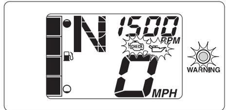
Se la spia di allarme pressione olio si attiva, ridurre immediatamente il regime motore, tornare a riva e controllare il livello dell'olio motore. (Vedere pagina 48 per informazioni sul controllo del livello dell'olio motore.) Se il livello dell'olio è insufficiente, far controllare la moto d'acqua da un concessionario Yamaha.
