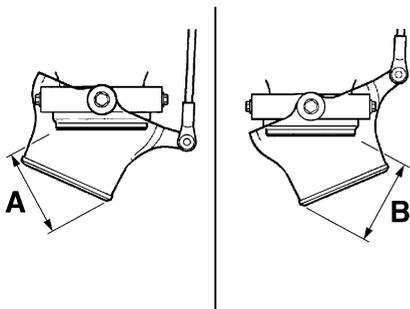
Differenza tra le posizioni di rotazione completa dell'ugello direzionale dell'idrogetto (distanze A e B):
