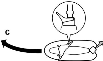
D. Se si spegne il motore durante la marcia, viene a cessare la spinta. La moto d'acqua proseguirà dritta anche se si gira il manubrio.
