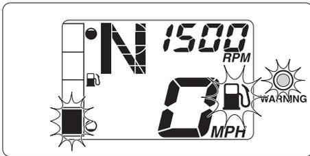
Se la spia di allarme livello carburante è attivata, rifornire il serbatoio del carburante al più presto possibile. (Vedere pagina 46 per informazioni sul rifornimento del serbatoio carburante.)
